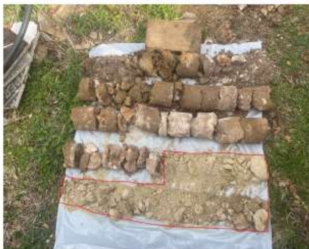
Slike 10 i 11: geotehnička sredina 3 u zasjeku iznad magistrale (slika lijevo) i u bušotini B-6 (slika desno)
