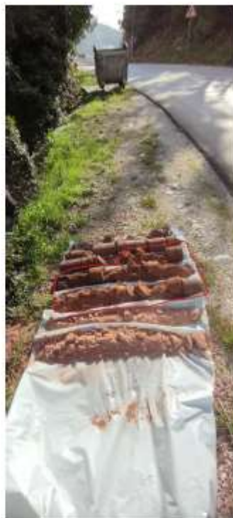
Slike 8 i 9: geotehnička sredina 2 (el) u bušotini B-2 (slika lijevo) i bušotini B-3 (slika desno)
