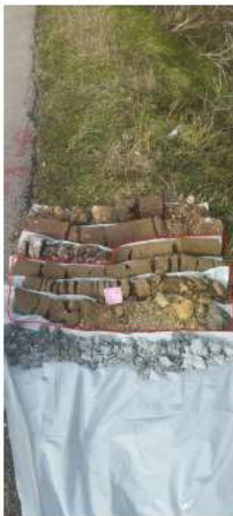
Slike 8 i 9: geotehnička sredina 2 (el) u bušotini B-2 (slika lijevo) i bušotini B-3 (slika desno)
